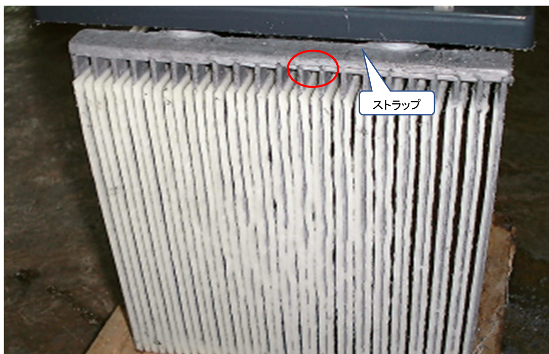
写真—2 MSE500AH 蓄電池の極板
