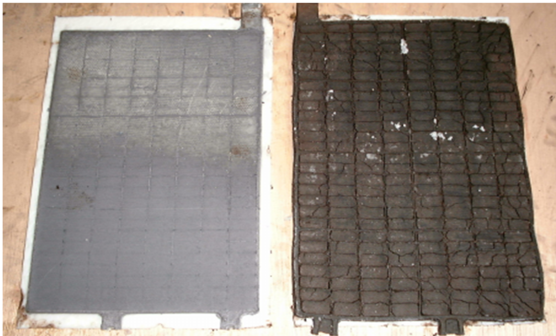
写真—3 格子の伸びによる極板不具合
