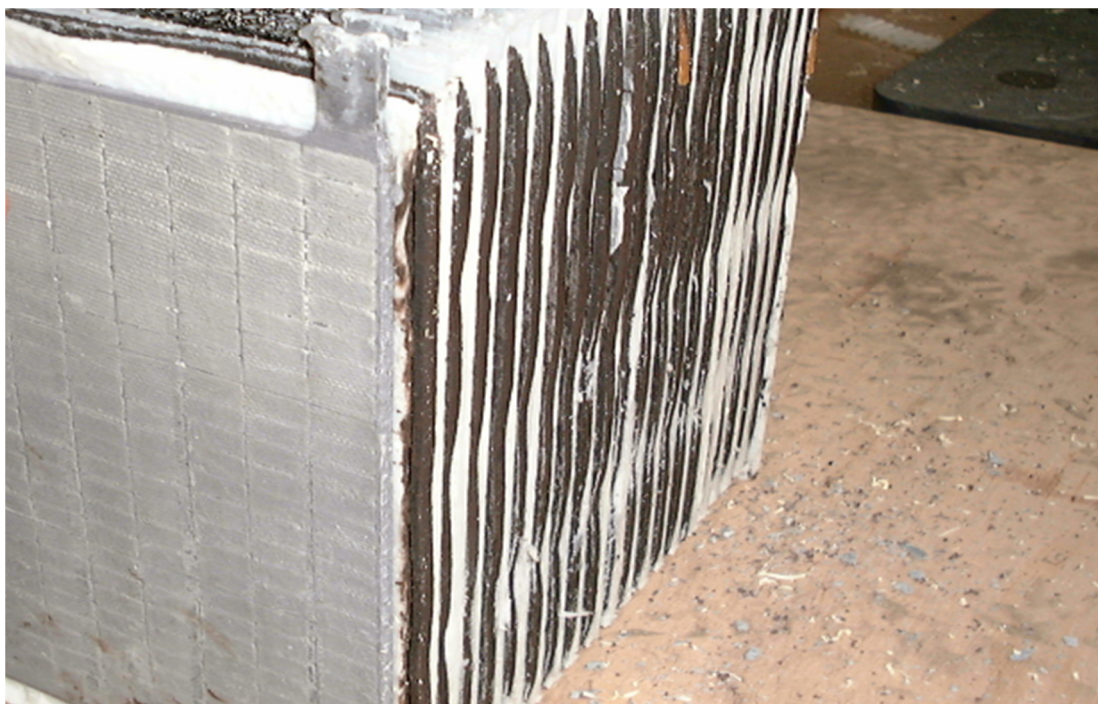
写真—4 プラス極板の伸びによる劣化
