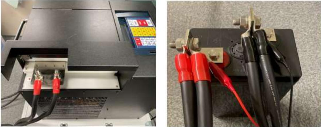
写真-1 実容量試験装置
